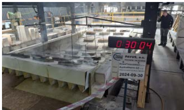
Kotvení desek EPS a EPS rozháněcích klínů
